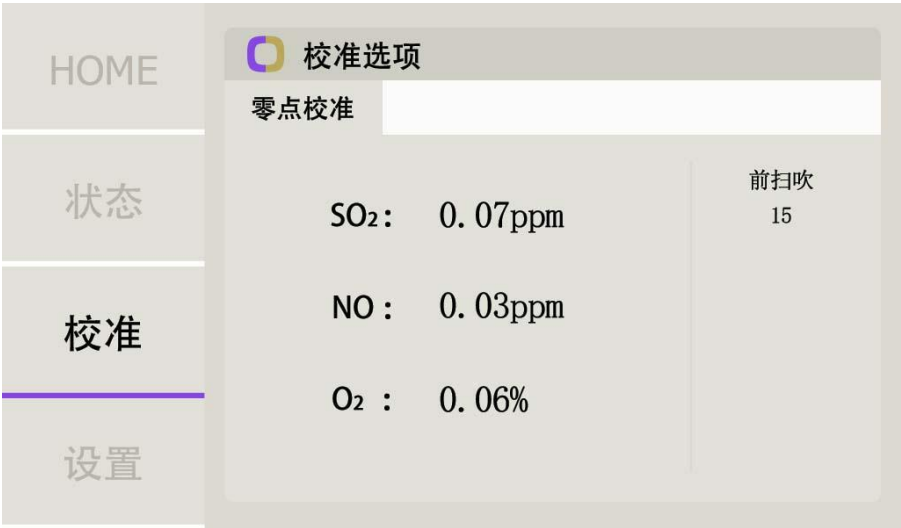
图 30 开关量输入零点校准前扫吹
