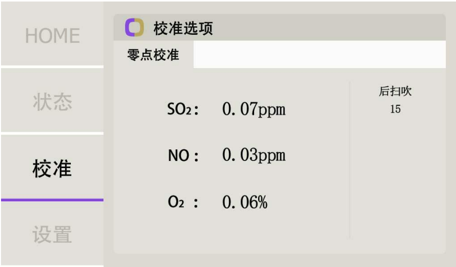
图 32 开关量输入零点校准后扫吹
